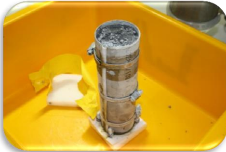
Abb. 41 Gefrorenes Kernmaterial vor dem Einbau in die Säule
