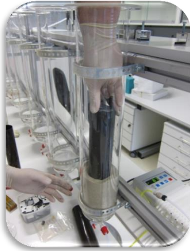
Abb. 42 Einbau des gefrorenen Kerns
