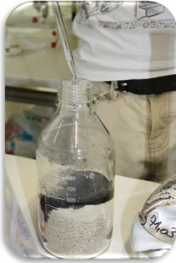
Abb. 19 Mischen des Kernes für den Säulenversuch
