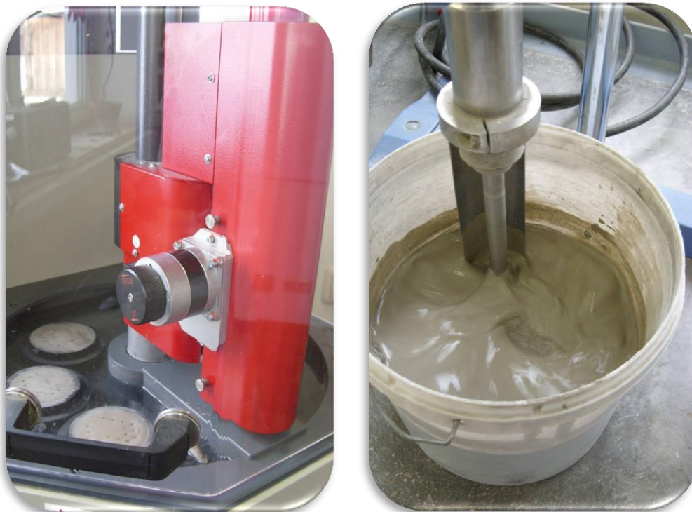
Abb. 14 Bestimmung der Abbindezeiten/ Ultraturrax-Mischgerät für Suspensionen
