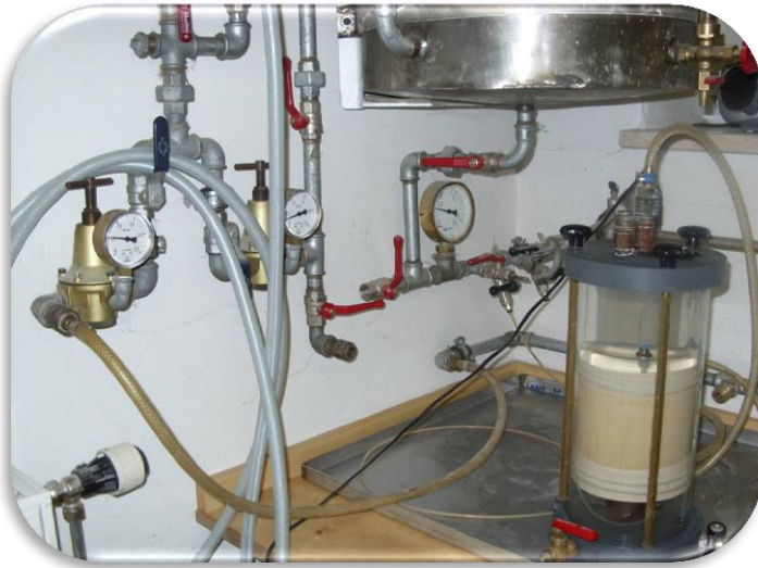
Abb. 15 Kf-Zelle zur Bestimmung der Durchlässigkeit des Baustoffs
